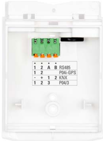
Abb. 14 Schließen Sie die Spannung +24 V DC/GND an den Klemmen 1/2 RS485 an (Klemmenbelegung polungsunabhängig).
